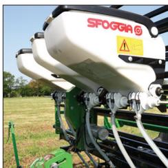
Microgranulateur PVC 18 L avec 1 sortie/distributeur volumétrique ou 32 L avec deux sorties/distributeurs volumétriques avec transmission mécanique ou électrique ou Isobus
