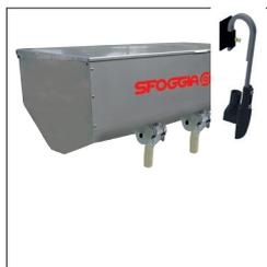
Épandeur d'engrais en inox 130/160 L, 1 - 4 rangs / distributeurs volumétriques avec soc à ressort flexible ou à disques avec transmission mécanique ou électrique ou Isobus
