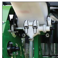
Microgranulateur arrière mécanique
