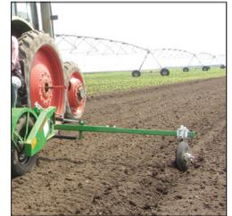
Traceur hydraulique pour châssis fixe
