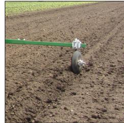
Traceur mecanique avec disque
