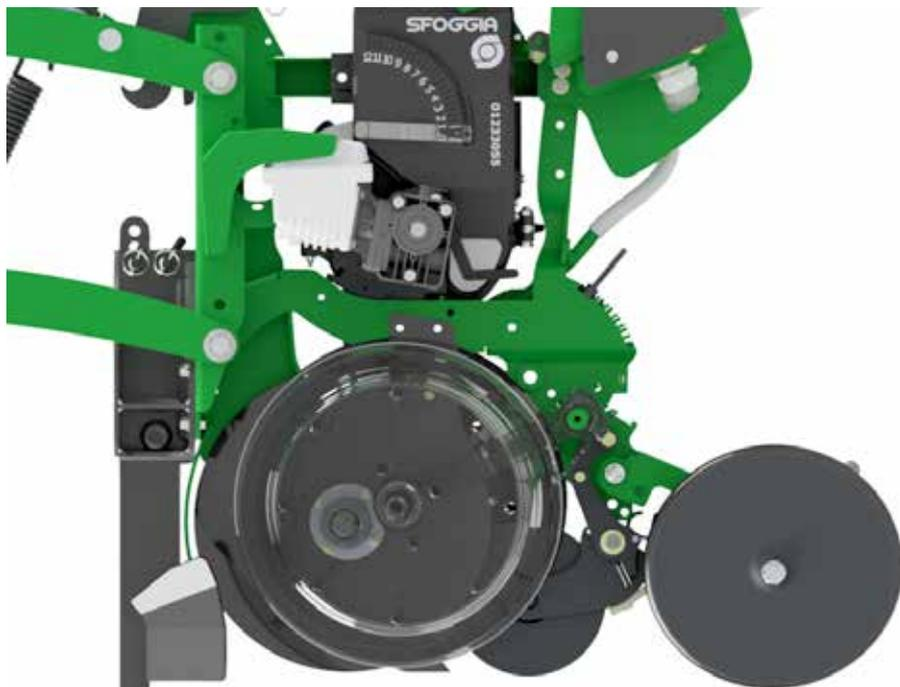
Zwischendruckrolle aus Stahl mit der Möglichkeit von schneller Abschaltung
