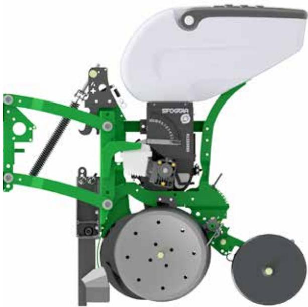
SÄAGGREGAT MIT ELEKTRA / ELEKTROANTRIEB + ISOBUS UND
