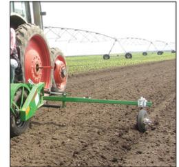
Segnafile idraulico per telaio fisso
