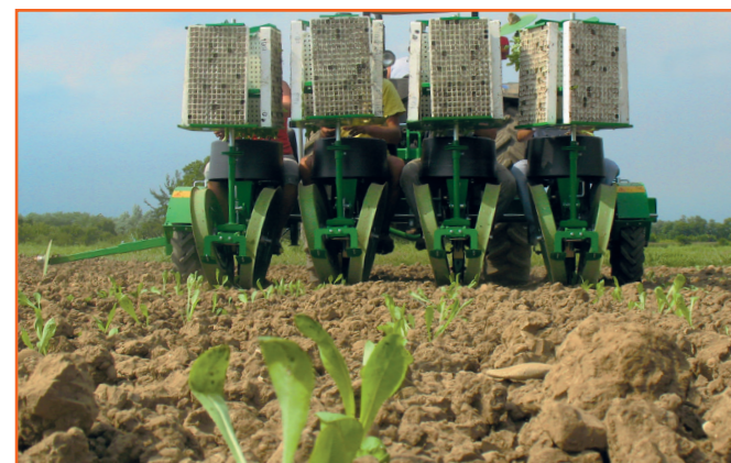
Elemento di trapianto Planting unit Pflanzaggregat Узел для высадки рассады Cuerpo transplantador
