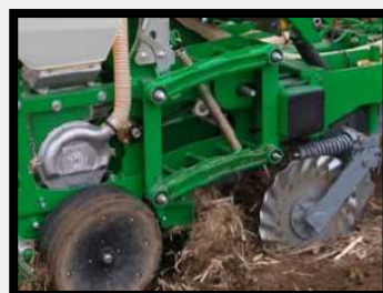
Bracci del parallelogramma montati su cuscinetto (a richiesta). Molla pressione elementi rinforzata.
