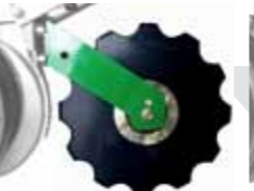
Disco singolo crantato aprisolco seme Toothed opener disc Disque ouverture dentés Disco abrisurco dentado
