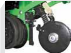
Disco doppio aprisolco concime Double opener disc manure Double disque ouverture fertiliseur Doble disco abrisurco fertilizante
